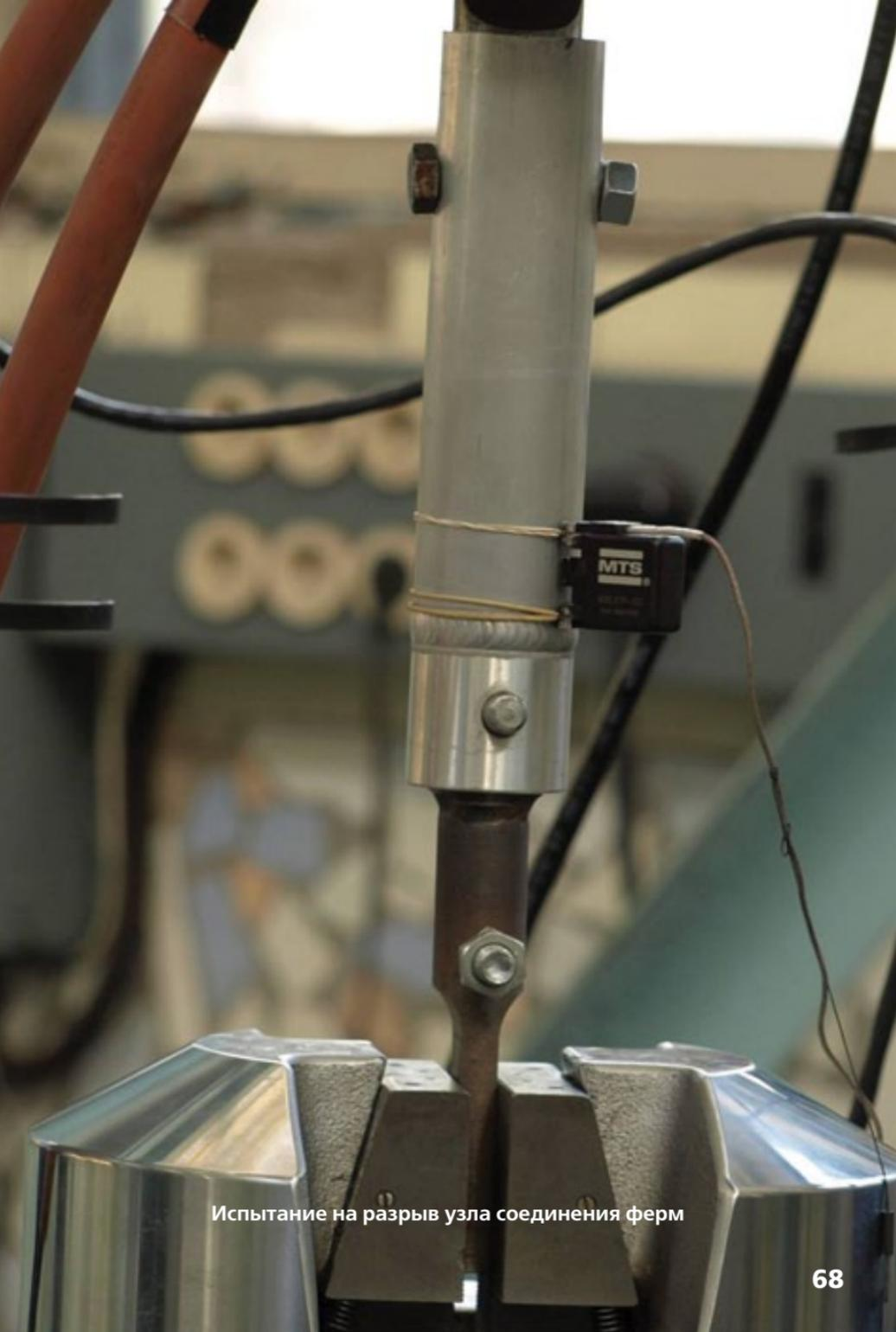
Испытание на разрыв узла соединения ферм
